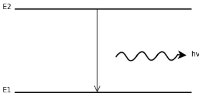
3. **Induzierte Emission:** Ein Photon aus dem Strahlungsfeld erzwingt eine Emission. Dabei kehrt ein Elektron aus dem höheren in einen niedrigeren Energiezustand zurück. Die Energie des Photons muss gleich dem Unterschied der Zustandsenergien sein. Damit werden dann zwei gleiche Photonen emittiert. 1. Aus dem Energieunterschied (spontane Emission) und 2. aus der Anregung.
