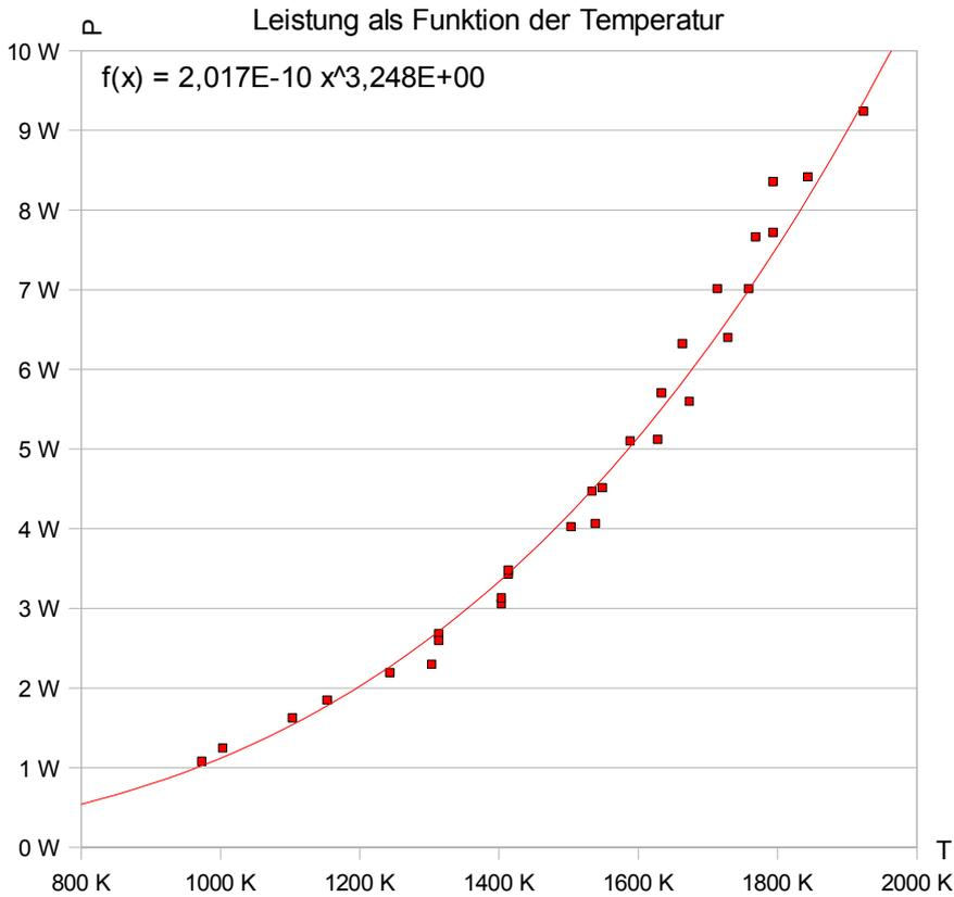
Man kann erkennen, dass es keine Ausreißer gibt. Bei genauerem Betrachten sieht man, dass im mittleren Bereich des Diagramms die meisten Werte unterhalb der Kurve liegen, während an den Rändern das Groß der Werte oberhalb der Kurve liegt. Das deutet darauf hin, dass unsere Parameterdarstellung bzw. die Werte korrigiert werden müssen. Der Exponent liegt bei 3,2 und bestätigt das Stefan-Boltzmann-Gesetz nicht.
